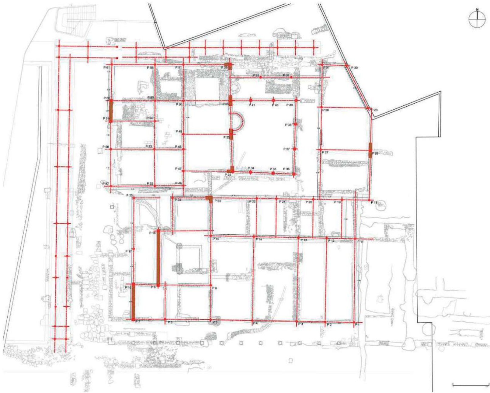
MICROESTACAS E REFORÇOS METÁLICOS EM AUMENTO PAREDE ESTRUTURAL
